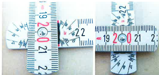
Abb. 9c: Winkelaufdruck auf der Vorderseite des zweiten Gliedes Figure 9c: angular print on the front-side of the second segment
